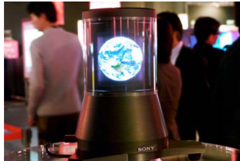
デジタルコンテンツ EXPO2009 において、ソニーが新開発の 360 度どこからでも見られる裸眼立体視ディスプレイを初披露
